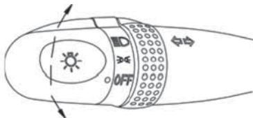
OFF - выключает наружное освещение. Первое положение переключателя - включает габаритные огни, подсветку приборной панели, подсветку других элементов управления систем автомобиля. Второе положение - включает фары ближнего света.
