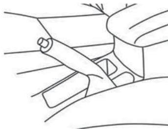
После остановки автомобиля вы должны поднять стояночный тормоз, чтобы не допустить самопроизвольного движения автомобиля во время стоянки.
