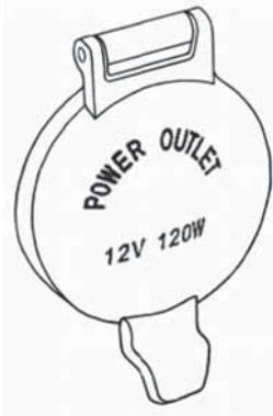
Розетка для питания внешних приборов расположена под защитной крышкой, с левой стороны. Розетка используется для питания внешних электроприборов, например автомобильных холодильников и т.д.
