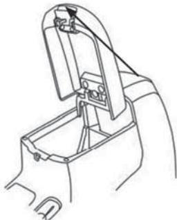
Данный ящик расположен в центральном подлокотнике. Нажав клавишу со стороны водителя, можно открыть нижний отсек ящика. Нажав клавишу со стороны переднего пассажира, можно открыть только верхний отсек ящика.
