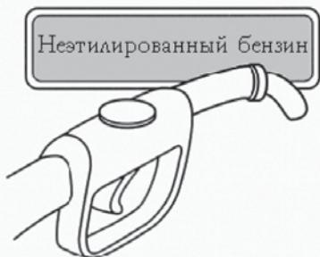
Данный автомобиль (с бензиновыми двигателями) оборудован узкой заливной горловиной, к которой подходят «пистолеты», заправляющие только неэтилированным топливом.
