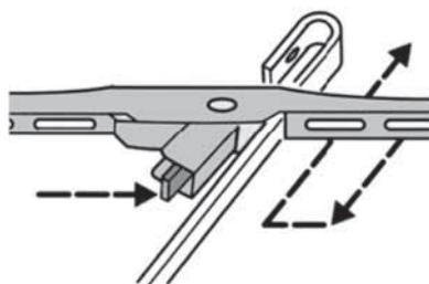
Поднимите стеклоочиститель и поверните щетку под углом. Нажмите на фиксатор и снимите щетку, потянув за держатель стеклоочистителя.
