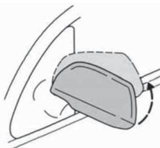
Наружные зеркала заднего вида, в случае необходимости, можно сложить. Например, для освобождения большего пространства в узких местах. Складывание производится за корпус зеркала движением к задней части автомобиля. Возвращать зеркала в исходное положение следует в противоположном на-
