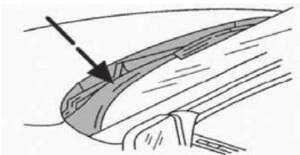
При стоянке в течение длительного времени на открытом воздухе с включенным двигателем следует открыть окно автомобиля хотя бы на 2,5 см. Либо, чтобы обеспечить доступ свежего воздуха в салон автомобиля, включите вентилятор системы вентиляции салона. Для обеспечения нормальной работы системы вентиляции удалите снег, листья и иные посторонние предметы, которые закрывают воздухозаборник вентиляционной системы и мешают нормальной циркуляции воздуха.
