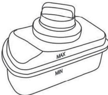
При холодном двигателе уровень жидкости достигает отметки MAX. Если уровень жидкости ниже отметки MIN, добавьте жидкость.
