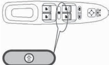
В водительской двери расположена еще одна кнопка для управления стеклами задней двери. Нажатие на эту кнопку приводит к блокированию управления задними стеклоподъемниками. Данная функция доступна только со стороны водительской двери. Ее рекомендуется использовать, когда на заднем сиденье находятся дети.
