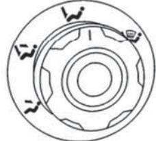
Установите переключатель режима обдува в нужное положение, чтобы система вентиляции и кондиционирования распределяла воздушный поток в направлении указанном на регуляторе режима обдува.
