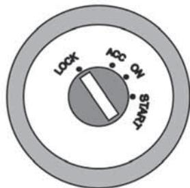
Замок рулевого колеса и замок зажигания встроенного типа имеют следующие режимы:
