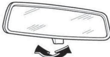
Для уменьшения ослепляющего действия фар едущих сзади вас автомобилей, вы можете переключить рычаг переключения в режим «против ослепления», отрегулировав угол наклона зеркала заднего вида для ночного вождения.
