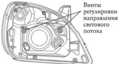
Винты регулировки направления светового потока
