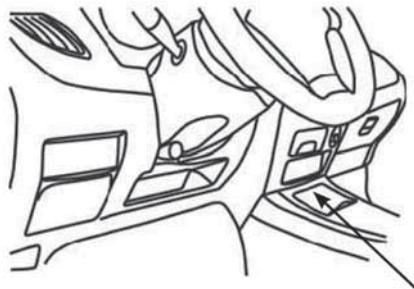
Малый вещевой ящик расположен в верхней части вторичной приборной панели. Чтобы открыть ящик, нажмите на кнопку.
