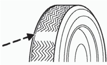
Регулярно проверяйте состояние шин на наличие царапин, присутствие посторонних предметов или неравномерного износа протектора. Причиной неравномерного износа протектора может явиться то, что колесо не отбалансировано. Технические нормативы и правила дорожного движения устанавливают нормы глубины рисунка протектора шины. Когда глубина износа достигает 3 мм, нашине появляется индикатор износа, указывающий на то, что шину необходимо заменить для надежной и безопасной эксплуатации автомобиля.
