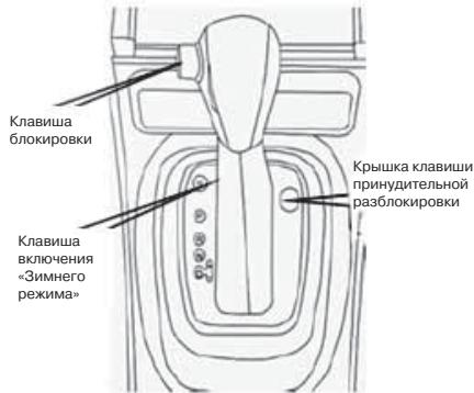
Изменение режимов работы АКПП осуществляется путем перемещения рычага селектора АКПП. Все положения селектора отображаются на указателе на приборной панели.
