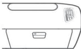
Перчаточный ящик расположен в правой нижней части приборной панели. Чтобы открыть ящик, нажмите на кнопку.
