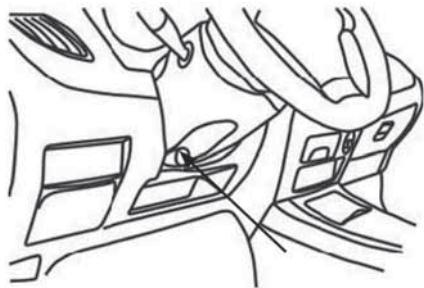
Для удобства и безопасности иногда требуется отрегулировать руль в желаемое положение. Потяните за рычаг регулировки высоты руля вверх (рычаг
