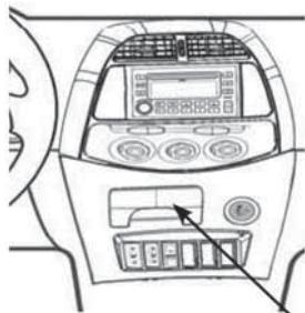
Передняя пепельница расположена по центру консоли. Для открывания поднимите крышку пепельницы. Для очистки пепельницы следует вытащить ее из гнезда.
