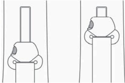
Не допускайте, чтобы ремень безопасности проходил через области шеи. Удерживая нажатой блокировочную кнопку регулировки высоты ремня, перемещайте крепление ремня вверх или вниз, чтобы добиться расположения ремня посередине плеча. Затем отпустите блокировочную кнопку и подержите за крепление ремня, чтобы убедиться, что он надежно зафиксирован.
