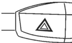
В аварийных ситуациях мигающий сигнал аварийной остановки предназначен для предупреждения впереди и сзади идущих автомобилей.
