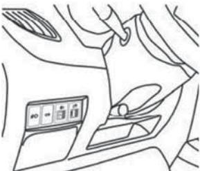
Ручка регулировки фар расположена под приборной панелью с левой стороны, рядом с переключателем противотуманных фар.
