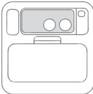
Выключатель с правой стороны предназначен для включения / выключения передней лампы внутреннего освещения. Нажмите на выключатель для включения передней лампы внутреннего освещения, для выключения – нажмите выключатель повторно. Выключатель с левой стороны предназначен для включения / выключения потолочного света.
