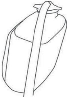
**!** Не открывайте бачок при разогретом двигателе.
