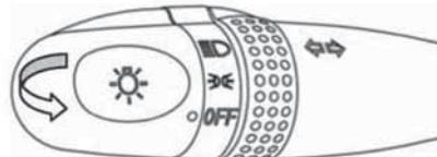
Для включения дальнего света фар двигайте соответствующую рукоятку (см. рисунок) по направлению к приборной панели. При этом световой индикатор включения режима дальнего света также загорится на приборной панели. Перемещение упомянутой рукоятки в исходное положение (по направлению к рулевому колесу) включает режим ближнего света фар автомобиля.
