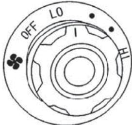
С помощью данного регулятора контролируется скорость работы вентилятора. Чтобы выключить вентилятор, поверните ручку в положение «OFF».
