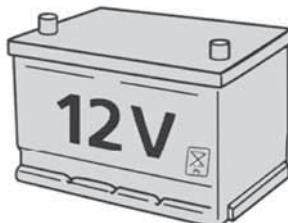
Аккумуляторная батарея не требует большого ухода. Ее состояние будет проверено при техническом осмотре автомобиля. Бортовая аккумуляторная батарея автомобиля совершенно не требует ухода. Не используйте аккумуляторную батарею другого типа. Напряжение и сила тока новой аккумуляторной батареи должны соответствовать техническим характеристикам, указанным компанией «Чери». За дополнительной информацией обратитесь в сервисный центр компании «Чери».
