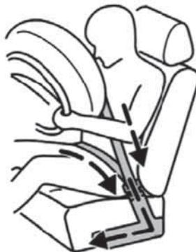
**!** Никогда не снимайте инерционный блокирующий механизм ремней безопасности. Ремонт инерционного блокирующего механизма может осуществляться только квалифицированными специалистами.
