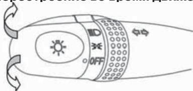
При перемещении рукоятки вверх/вниз до соответствующего ограничительного момента, будет вспыхивать определенный сигнал поворота. При этом контрольная лампа сигнала поворота также будет вспыхивать на приборной панели.
