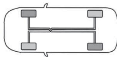
Ваш автомобиль оборудован двухконтурной тормозной системой. При отказе одного из контуров автомобиль можно остановить при помощи другого.
