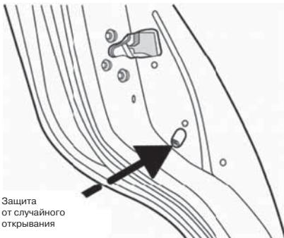
«Защиту от случайного открывания детьми» можно активировать, сдвинув вперед рычаг блокировки замка задних дверей. В таком положении дверь можно открыть только снаружи. Для того чтобы снять блокировку замков задних дверей, следует сдвинуть рычаг блокировки замков назад. На рисунке показано расположение рычага блокировки замков дверей «от детей». Сдвинув вперед данный рычаг, вы можете заблокировать замок от возможности открывания двери изнутри.
