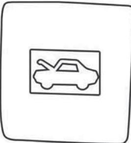
1. Рукоятка открывания замка капота расположена с левой стороны от водителя под панелью приборов. Если потянуть рукоятку на себя, капот немного приоткроется.
