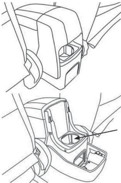
Подстаканник задних сидений расположен на задней консоли. Чтобы пользоваться подстаканником, снимите крышку.
