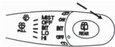
Потяните рычаг управления стеклоочистителем на себя в направлении рулевого колеса, при этом моющая жидкость будет подаваться на стекло и автоматически несколько раз сработают стеклоочистители. Отпустите рычаг, подача моющей жидкости прекратится (стеклоочистители при этом будут некоторое время работать).
