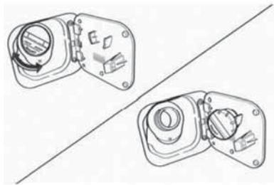
Крышку заливной горловины топливного бака можно открыть изнутри автомобиля с помощью рукоятки открытия крышки заливной горловины, расположенной рядом с сиденьем водителя.
